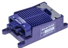
Schnellanschluss-Abgangsdose IP20/IP40 mit 3-Poliger Buchse Code1, Belegung L1-N-PE, 250V 20A, für Flachkabel Art.
