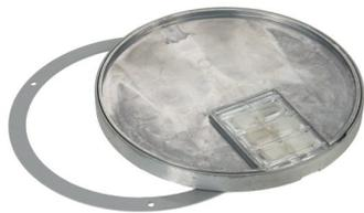
Cadre et couvercle en aluminium coulé sous pression avec anneau intermédiaire avec bord de protection, pour revêtement de sol 5mm avec passage de câble Art. n° 52573 y compris pièce de remplissage 51877
