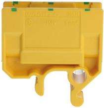
Abzweigklemme ohne Druckstück, Gewindestifte mit Schlitz, Metallteile Messing vernickelt, Spreizschuttschieber für Leiter durchgehend, 4-stellige Bezeichnungsmöglichkeit
