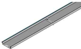
mit integrierter Nivellierung aus sendzimir-verzinktem Stahlblech 1.5mm beidseitig in Spezialaluminiumprofil Woertz eingepresst mit provisorischer Schutzkante in Nut eingelegt und Trittschalltrapezgummi als Deckelaufgabe
