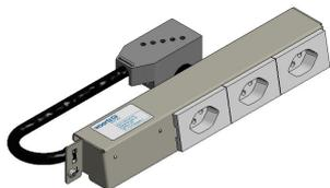
Kit di installazione presa di corrente T13 3FLF orizzontale SB BOK in lamiera d'acciaio zincata da 1,5 mm con vite zigrinata per il fissaggio laterale nella canalina. Dimensioni: 302x47(53)x40mm Colore: grigio ghiaia RAL 7032 Dotazione, cablaggio e collaudo: 1 pz. terminale a foro cieco 7x2,5mm<sup>2</sup> 10127 3 pz. presa di corrente T13 FLF bianco 55200 1x L1 / 1x L2 / 1x L3 1 pz. Cavo Td 5x1,5mm<sup>2</sup> / 1000mm 1 pz. Scatola di giunzione FK technofil 49909 (10A)
