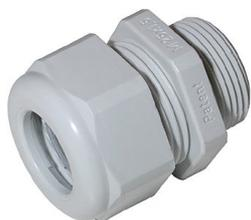
Presse-étoupe M16x1,5 avec joint torique, plage de serrage Ø 4,5 à 6,0 mm en plastique pour boîtes de dérivation IP68
