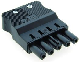
5 polige Buchse Code 1 mit Schraubanschluss und Zugentlastung zur Selbstkonfektionierung - max. 400V / 16A- schwarz, halogenfrei. Für Kabel Durchmesser Ø 9.3 - 10.3 mm
