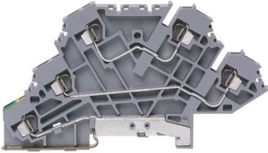
Querschnittbereich 0.2-1.5mm 2mit Schutzleiteranschlussfeder aus rostfreiem Stahl Verbindungssteg aus Kupfer verzinkt
