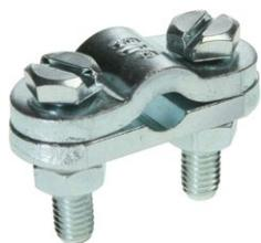
Abrazadera de cobre con tornillos de acero, arandelas elásticas y tuercas para 1 conductor de hasta 50 mm 2
