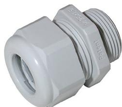
Presse-étoupe M25x1,5 avec joint torique, plage de serrage Ø 12,5-16,0 mm en plastique pour boîtes de jonction IP68
