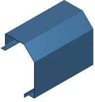
en tôle d'acier galvanisée 1.5mm
