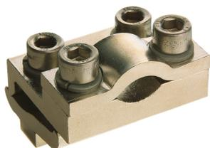
Zum Aufsetzen auf Flachkupferschienen bis max. 8mm Dicke Tatzeklemmen mit:- 2 Inbusschrauben aus Stahl M6 SW5 mit Federring für Schienenanschluss- 2 Inbusschrauben aus Stahl M6 SW5 mit Federring für Leiteranschluss
