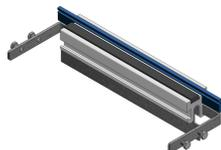
en tôle d'acier galvanisée sendzimir 1.5mm pressée dans un profilé d'aluminium spécial Woertz avec bord de protection provisoire inséré dans la rainure et caoutchouc trapézoïdal d'insonorisation des bruits d'impact comme support du couvercle, matériel d'assemblage inclus Hauteur 80mm / largeur nominale du couvercle 200mm
