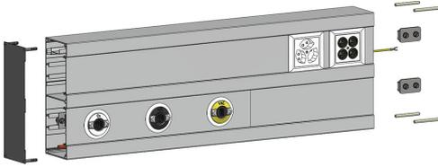
Verwendung als medizinische Versorgungseinheit horizontal aus Aluminium-Profil 2.2mm 2-zügig in der Mitte getrennt unten mit 5 Stk.  $\varnothing$  9 Bohrungen für Gasabfluss mit Kombischienen zur Montage der Einbauapparate inklusive Verbindungsmaterial und Erdlitze Farbe: nach Wahl Länge: 2000mm
