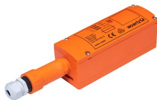
Boîtier de dérivation E90 avec adaptateur de fusible IP66/68 pour câble plat WOERTZ FE180 E90 5G6.0mm<sup>2</sup> avec 3 presse-étoupes M20x1.5 Ø6.0 - 15.0mm Conception spécifique au projet sur demande (voir Document/G00'299)
