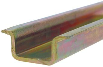
Tragschiene DIN35 mit 35x15x2.5 mm, aus Stahl galvanisch verzinkt, mit einem 50 mm<sup>2</sup> Kupferquerschnitt nach EN 60715, 2 m Länge.
