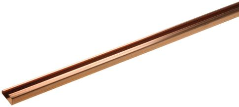
Tragschiene DIN32 mit 32x15x1.5 mm, aus Kupfer, mit einem 150 mm<sup>2</sup> Kupferquerschnitt, 2 m Länge.
