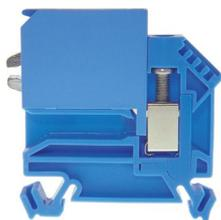
Sectionneur de neutre bleu DIN35 6mm<sup>2</sup> 52x8x52mm avec raccordement pour barre omnibus, détachable, longueur de dénudage du conducteur : 15,5mm
