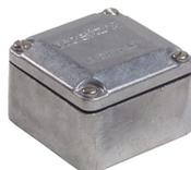
**Boîte de dérivation en fonte d'aluminium type OB sans pieds de fixation jusqu'à 6x1.5 mm<sup>2</sup>, 400V, 64x64x41 mm**
