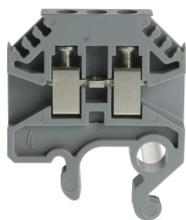
Reihenklemme DIN32 2.5mm<sup>2</sup> grau. Zu Tragschiene nach EN 50035-G 32 Isolierkörper, aus Polyamid 6.6 Beidseits 3-stellige Bezeichnungsmöglichkeit Zugbügel und Verbindungssteg aus Messing vernickelt Schrauben aus rostfreiem Stahl Metallteile unverlierbar. Für Querverbindungen über klemmen. Schutzklemmen mit Verbindung zur Tragschiene.
