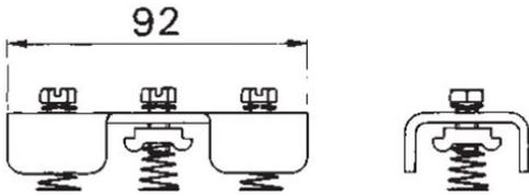
aus Stahlblech 3mm , verzinktmit Sechskant-Schlitzschrauben aus Stahl verzinkt M16x16,Federringen und Nutensteinzum Einsetzen in Profilschiene Nr. 4283, Typ C30mit 4 Schrauben und 2 Ankerplatten 50mm lang
