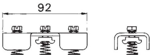
de chapa de acero de 3 mm, galvanizada con tornillos de ranura hexagonal de acero galvanizado M16x16, arandelas elásticas y tuercas de ranura para insertar en el carril de perfil nº 4283, tipo C30 con 4 tornillos y 2 placas de anclaje de 50 mm de longitud
