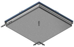
aus sendzimir-verzinktem Stahlblech 1.5mm beidseitig in Spezialaluminiumprofil Woertz eingepresst mit provisorischer Schutzkante in Nut eingelegt und Trittschalltrapezgummi als Deckelauflage inklusive Befestigungsglaschen und Verbindungsmaterial Höhe 60mm / Deckelnennbreite 300mm
