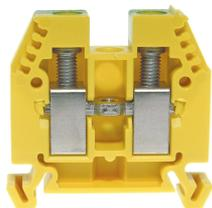
Bloque de terminales DIN35 16mm<sup>2</sup> 45x11x42mm verde-amarillo aislado con el mejor contacto posible, tornillos de acero inoxidable, opción de marcado de 4 dígitos en ambos lados, empotrado para conexiones cruzadas
