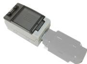
Zubehör für Abzweigdose 49615 Anwendung : Absicherung von Einspeisung oder Unterverteilung bis 76A. Ausgangsseitig ausbrechbar für Kabelverschraubungen M25, M32, M50 (Kabelverschraubung Ausgangsseite nicht im Lieferumfang enthalten).
