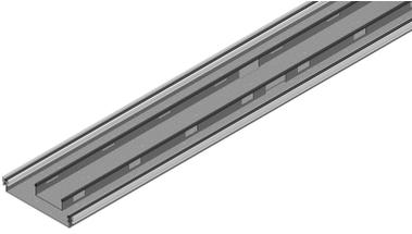
aus sendzimir-verzinktem Stahlblech 1.5mm beidseitig in Spezialaluminiumprofil Woertz eingepresst mit provisorischer Schutzkante in Nut eingelegt und Trittschalltrapezgummi als Deckelauflage inklusive Befestigungslaschen und Verbindungsmaterial Höhe 50mm / Deckelnennbreite 300mm Länge: 2000mm
