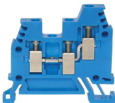
Terminal serie Y DIN35 4mm<sup>2</sup> azul con 3 conexiones con tornillos de acero inoxidable, opción de marcado de 3 dígitos en ambos lados, empotrado para conexiones cruzadas
