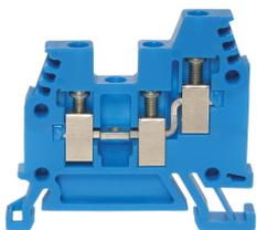
Terminale serie Y DIN35 4mm<sup>2</sup> blu con 3 connessioni con viti in acciaio inox, possibilità di marcatura a 3 cifre su entrambi i lati, incasso per connessioni incrociate
