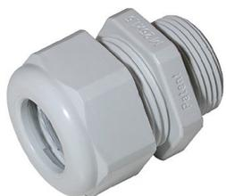
Pressacavo M20x1,5 con O-ring, campo di serraggio Ø 8.0-11 mm in materiale plastico per scatole di giunzione IP68
