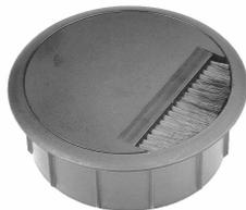
Aus Polyamid schwarz, mit Schutzflansch 3 mm abgeflacht, mit Bürstenleiste schwarz, für Bohrung Ø111mm.
