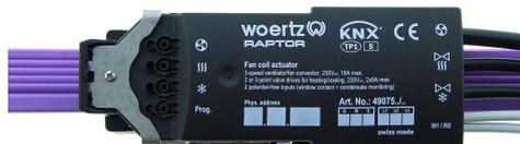
Raptor FanCoil-Aktor - für 2- bzw. 4-Rohr-Systeme - Heiz-/Kühlventile für 2-Punkt bzw. 3-Punkt-Antriebe, 230 V AC, 2 x 8 A max., 2 x 3-polige Buchsen Code 4 - 3-stufiger Lüfter, 230 V AC, 16 A max., 5-polige Buchse Code 1 - 2 potentialfreie Eingänge: Fensterkontakt und Kondensatüberwachung, 2 x 2-polige Stecker Code Woertz - Einspeisung, Phase L2 - KNX-Buskoppler integriert - IP20
