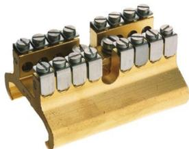
Schutzleiterklemme DIN35 25/6mm<sup>2</sup> 63.5x48x33.5mm blank mit 1 Hauptanschluss 25 mm<sup>2</sup> und 16 Nebenanschlüsse 6 mm<sup>2</sup>. Schrauben und Federn aus rostfreiem Stahl
