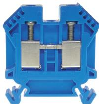
Bloc de jonction DIN35 10mm<sup>2</sup> 52x9x51mm bleu avec le meilleur contact possible, vis en acier inoxydable, possibilité de repérage à 4 chiffres des deux côtés, encastré pour les connexions transversales
