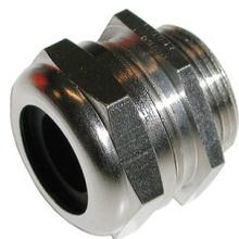
Kabelverschraubung M25x1.5 Klemm bereich Ø 11-20.5mm aus Messing vernickelt zu Anschlussdosen Nr. 49
