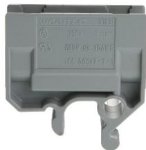
Borne de dérivation sans pièce de pression, vis sans tête avec fente, pièces métalliques en laiton nickelé, coulisseau de protection contre l'écartement pour conducteur traversant, possibilité de repérage à 4 chiffres
