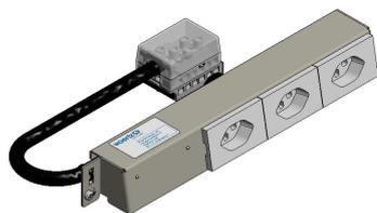
Einbausatz Steckdose T23 3FLF liegend SB BOK aus verzinktem Stahlblech 1.5mm mit Rändelschraube zur seitlichen Befestigung in der Kanalschale. Abmessung: 302x47(53)x40mm Farbe: RAL 7032 Kieselgrau bestückt, verdrahtet und geprüft: 1 Stk. Sacklochklemme 7x2.5mm<sup>2</sup> 10127 3 Stk. Steckdose T23 FLF weiss 55210 1x L1 / 1x L2 / 1x L3 1 Stk. Td-Kabel 5x2.5mm<sup>2</sup> / 1000mm 1 Stk. FK-Dose SK ecobus power 5x2.5<sup>2</sup> Pow 5P 49701P (16A)
