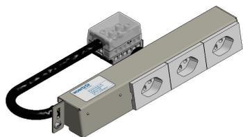
Kit de instalación toma T23 3FLF horizontal SB BOK de chapa de acero galvanizado de 1,5 mm con tornillo moleteado para la fijación lateral en la carcasa del canal. Dimensiones: 302x47(53)x40mm Color: RAL 7032 gris guijarro Equipado, cableado y probado: 1 ud. terminal de agujero ciego 7x2,5mm<sup>2</sup> 10127 3 ud. toma de corriente T23 FLF blanco 55210 1x L1 / 1x L2 / 1x L3 1 ud. Cable Td 5x2,5mm<sup>2</sup> / 1000mm 1 ud. Toma FK SK ecobus power 5x2,5<sup>2</sup> Pow 5P 49701P (16A)
