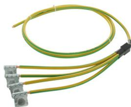
El juego de conexión, compuesto por un conductor aislado de 3 m de longitud (cable de 50 mm<sup>2</sup> Cu) y 4 placas de apriete prensadas para la conexión a 4 aceros longitudinales, sirve de conexión desde la toma de tierra de cimentación hasta los puntos de conexión en las superficies de las paredes interiores o exteriores del edificio.
