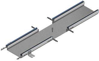
aus sendzimir-verzinktem Stahlblech 1.5mm beidseitig in Spezialaluminiumprofil Woertz eingepresst mit provisorischer Schutzkante in Nut eingelegt und Trittschalltrapez gummi als Deckelauflage inklusive Befestigungsglaschen und Verbindungsmaterial Höhe 60mm / Deckelnennbreite 200mm Länge: 1000mm
