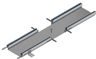
en tôle d'acier galvanisée senzimir 1.5mm longueur=1000mm avec arête de protection provisoire pour couvercle de largeur 200mm avec pattes de fixation et matériel de jonction
