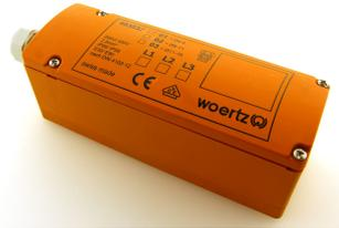
Brandsicherheitsdose IP66/IP68, 2-Schrauben-Kontaktierung zur abisolierfreien Einspeisung und Abzweigung, mit Schraubanschluss für Starkstrom 5G6 mm<sup>2</sup>, längs abgehend, inkl. 2 x Kabelverschraubungen M25x1.5, mit einem Klemmbereich von jeweils Ø 12.5-16 mm und Ø 16-20.5 mm
