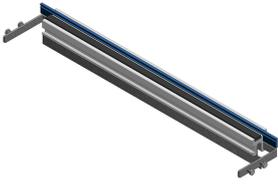
aus sendzimir-verzinktem Stahlblech 1.5mm in Spezialaluminiumprofil Woertz eingepresst mit provisorischer Schutzkante in Nut eingelegt und Trittschalltrapez gummi als Deckelauflageinklusive Verbindungsmaterial Höhe 50mm / Deckelnennbreite 400mm
