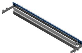
in lamiera d'acciaio zincata sendzimir 1,5 mm pressata in un profilo speciale di alluminio Woertz con bordo di protezione temporaneo inserito nella scanalatura e gomma trapezoidale antiurto come supporto del coperchio, compreso il materiale di collegamento altezza 50 mm / larghezza nominale del coperchio 400 mm
