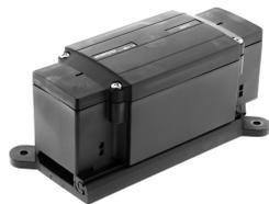
Boîtier de raccordement 5 pôles pour câble plat 5G16mm<sup>2</sup> ou 5G25mm<sup>2</sup> IP65 avec fixation avec 1 manchon fileté M40x1.5 pour 1 câble d'alimentation avec câble rond 5x16mm<sup>2</sup> et 5x25mm
