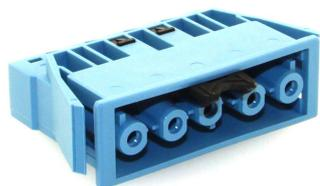
Conexión de aparato para sistema de enchufe Woertz, enchufe, azul pastel, código 2, 5 polos, bloqueable. Grosor mínimo de pared: 0,5 mm, grosor máximo de pared: 1,2 mm. Adecuado para conexiones de luminarias DALI en combinación con instalación de cable plano Woertz.
