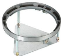
con marco Ø226 de aluminio fundido a presión para tapas con revestimiento de suelo de 8mm, altura del suelo 100-130mm
