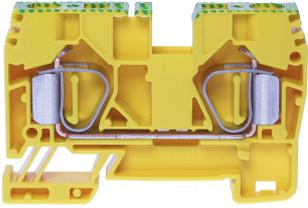
Zugfederklemme mit 2 Anschlüssen Bezeichnungsmöglichkeit seitlich und in der Mitte mit Streifen, für Querverbindung versenkt
