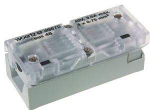
Caja de conexiones para cable plano Multibus 4x1,5mm<sup>2</sup> - 2 cables redondos 4x0,75mm<sup>2</sup> con 3 contactos de cable plano (Especialmente adecuado para unidades MP-Bus de Belimo)
