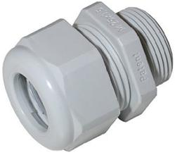
Kabelverschraubung M16x1.5 mit O-Ring, Klemm bereich Ø 6.0-8.0mm aus Kunststoff zu Anschlussdosen IP68
