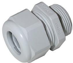
Presse-étoupe M16x1,5 avec joint torique, plage de serrage Ø 6.0-8.0mm en plastique pour boîtes de jonction IP68
